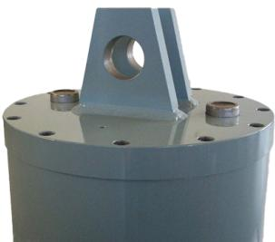
Tête supérieure avec support pour charnière soudé et normalisé, avec transformation du trou en tolérance H8 pour goujon d'assemblage.
